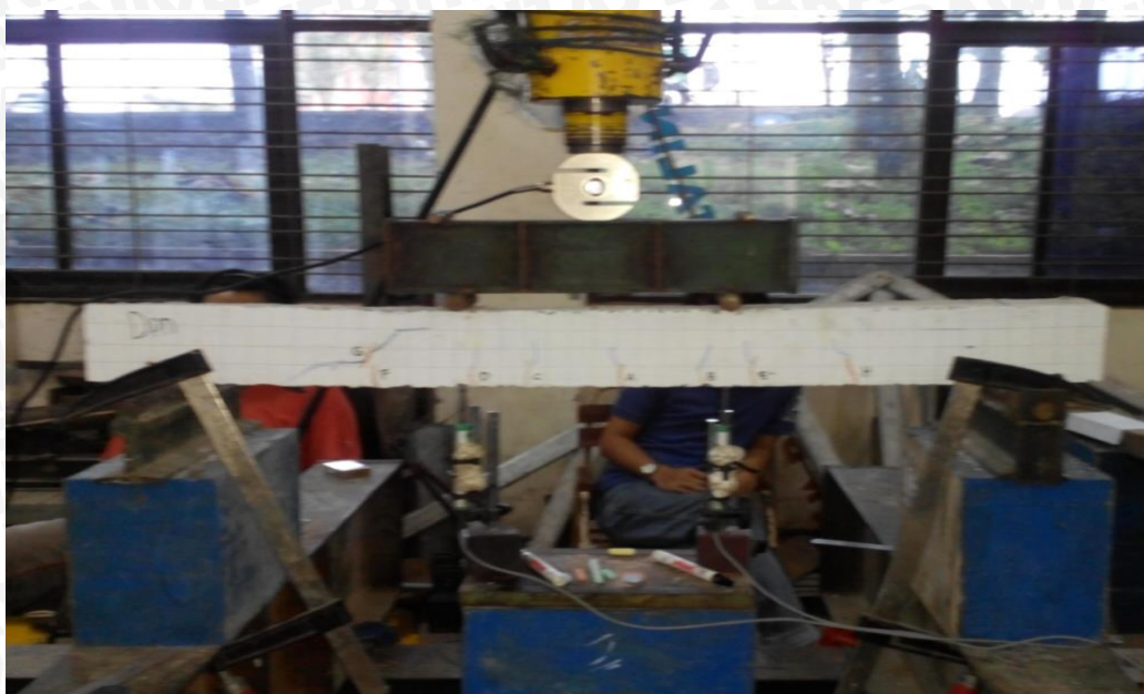
Gambar keruntuhan geser pada balok (0% bottom ash)
