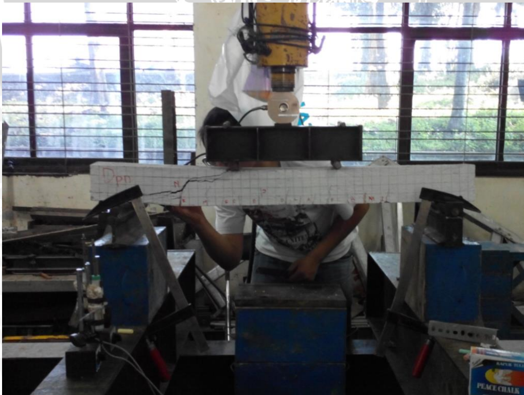
Gambar keruntuhan lentur pada balok (25% bottom ash)
