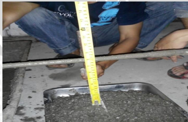
Gambar Pengujian Slump
