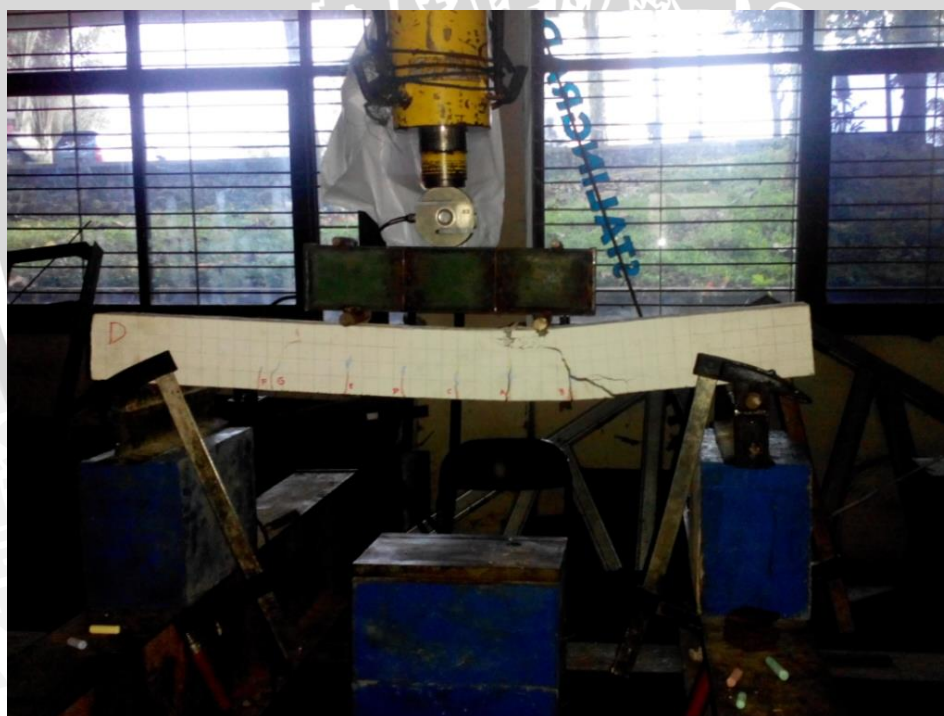
Gambar keruntuhan geser pada balok (10% bottom ash)
