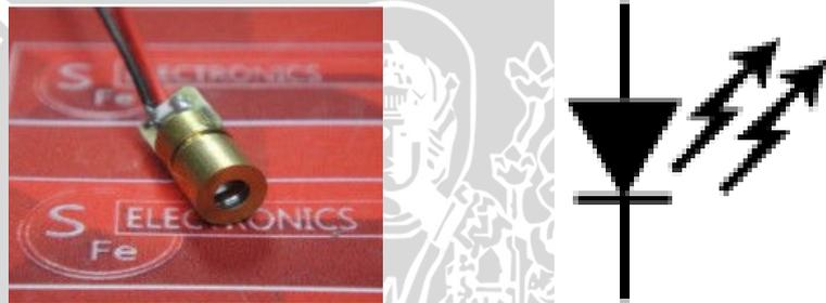
Gambar 2.8 Bentuk Fisik Dan Simbol Laser Diode
