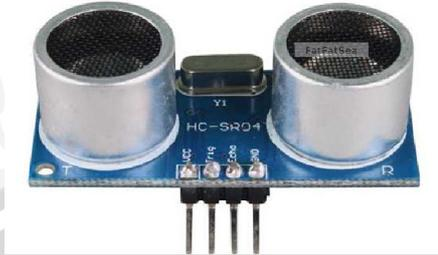
Gambar 2.2 Bentuk Fisik Sensor Ultrasonik HC-SR04
