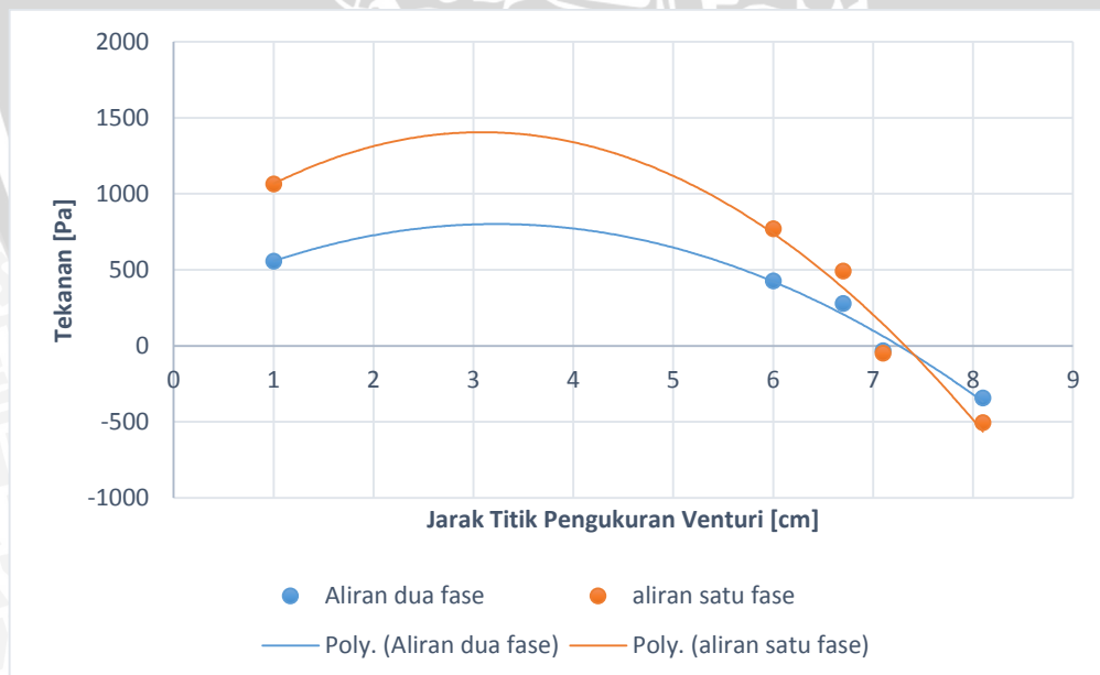
Gambar 4.2 Grafik Hubungan Jarak Titik Pengukuran Venturi Pada Aliran Satu Fase dan Dua Fase
