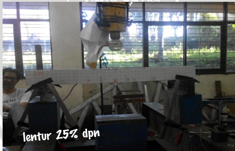
Keruntuhan lentur pada balok (25% bottom ash)
