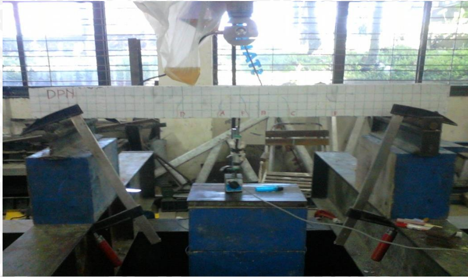
Keruntuhan lentur pada balok (0% bottom ash)
