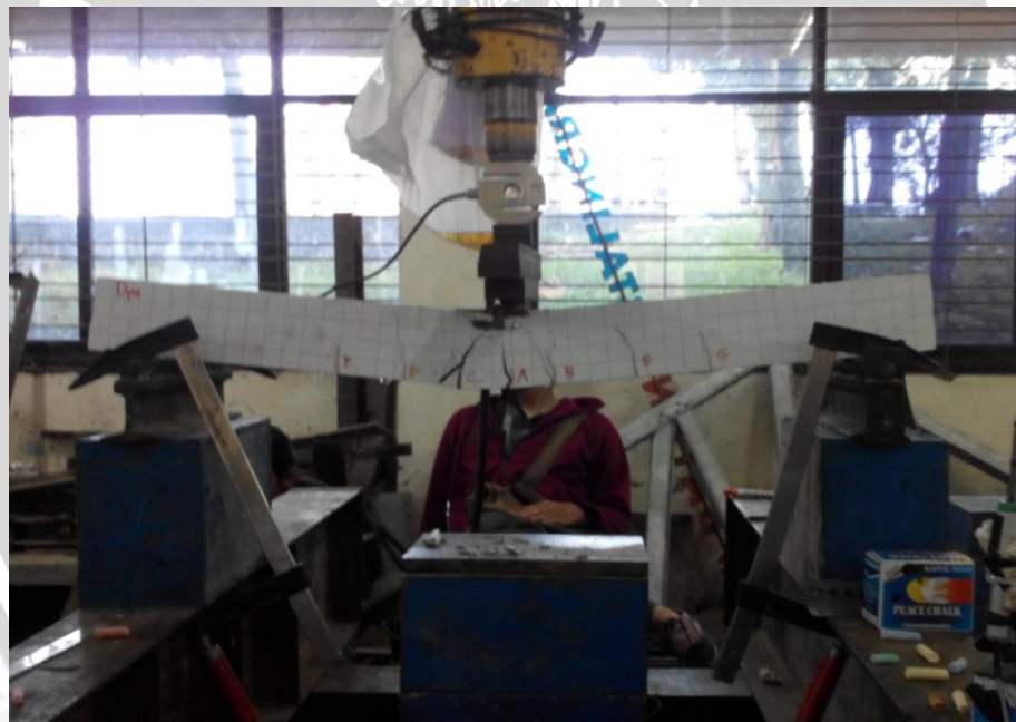
Keruntuhan lentur pada balok (10% bottom ash)
