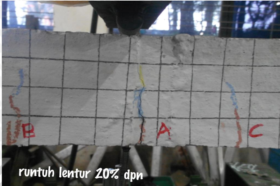
Keruntuhan lentur pada balok (20% bottom ash)
