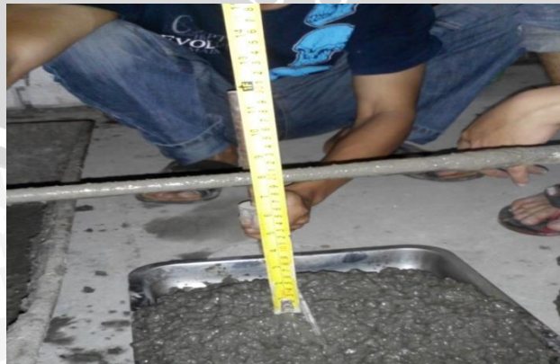
Gambar Pengujian Slump
