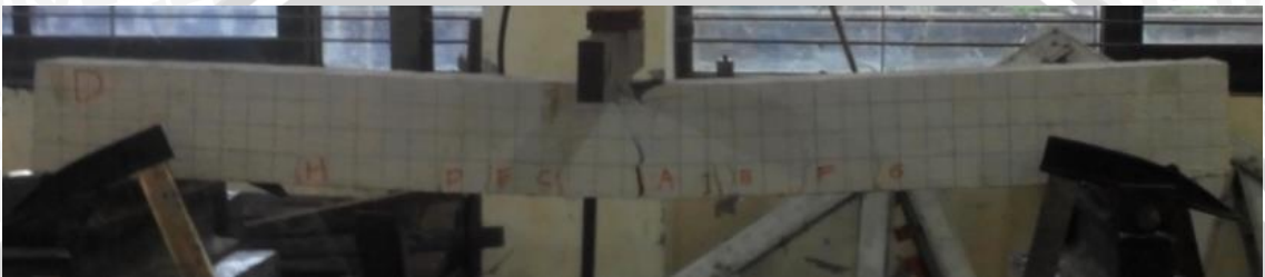
Gambar Balok Runtuh Lentur Perendaman 7 hari Kadar BA 0%
