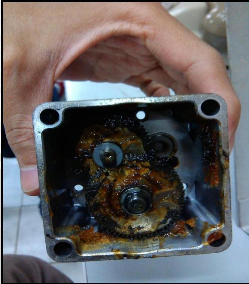
Proses pembongkaran motor DC agar dapat bergerak secara linier
