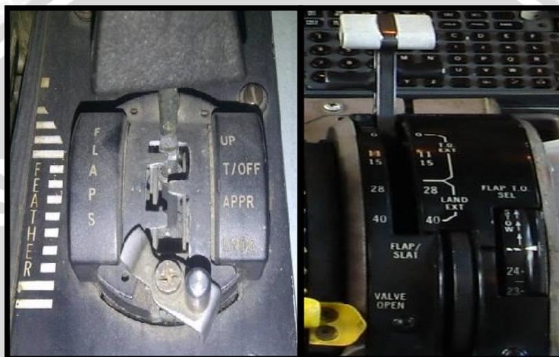
Gambar 2.3 Flap selector pada cockpit
