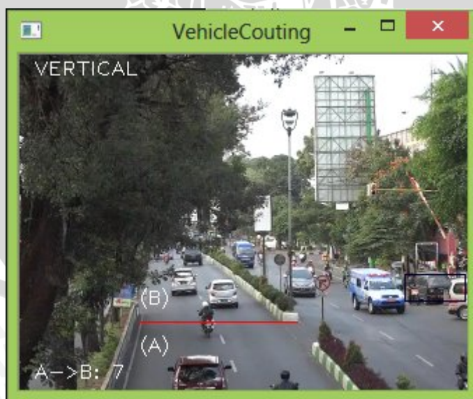
Gambar 5.15 Pengujian Program Penghitung Kendaraan Dengan Sudut 90°
