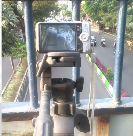
Gambar 4. Pengambilan Gambar Dengan Sudut 60^{\circ} Tampak Dari Belakang
