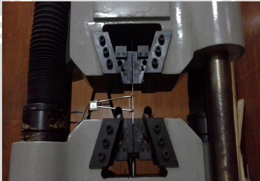
Gambar 3.2 Mesin Uji Tarik
