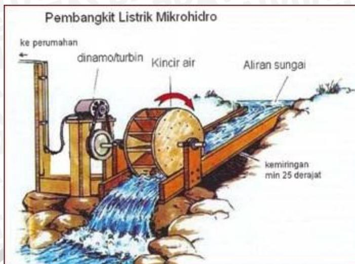
**Gambar 2.1** Skema Sederhana Pembangkit Tenaga Mikrohidro
