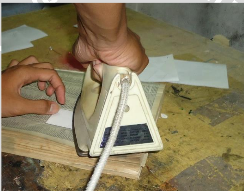
Gambar diatas adalah proses penyetrikaan kertas glossy pada lembar PCB FR4 E-poxy. Kertas yang ditempelkan pada lembar PCB tersebut merupakan kertas yang telah dicetak hitam oleh gambar patch antena perancangan
