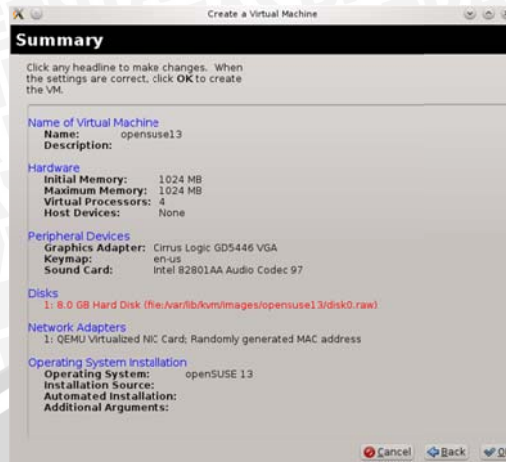
Gambar 4.20 Konfigurasi untuk alokasi hardware di dalam guest OS
