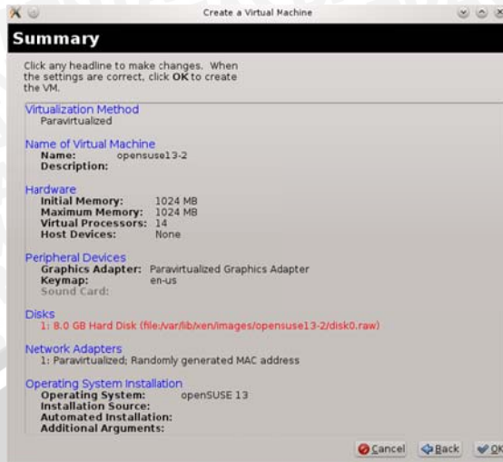
Gambar 4.29 Konfigurasi untuk alokasi hardware di dalam guest OS domU
