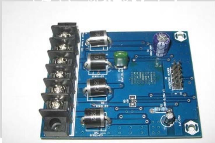
**Gambar 2.13** Pengendali motor DC menggunakan EMS 5A *H-Bridge* Koneksi Modul
