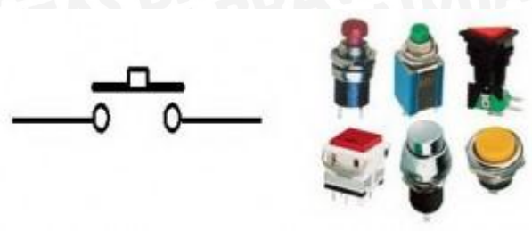
Gambar 2.10. Simbol dan macam bentuk Push Button Sumber : elektronika-dasar.web.id
