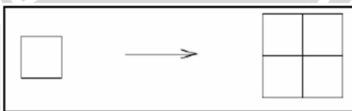
Gambar 3.3 Pembentukan subpiksel dengan  $m = 4$  subpiksel
