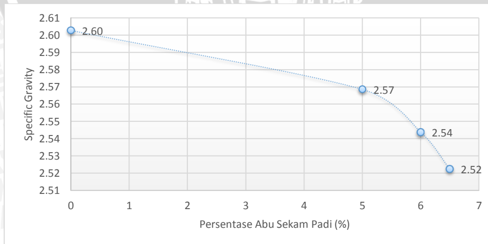
Gambar 4.1 Pengaruh penambahan abu sekam padi terhadap nilai specivic gravity
