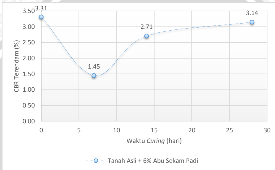
Gambar 4.11 Perbandingan Nilai CBR Terendam dengan Variasi Waktu Curing
