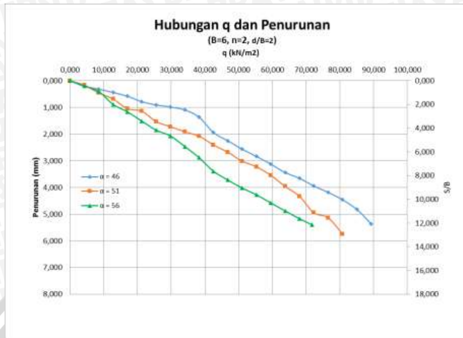
Gambar 4.23 Grafik Hubungan Q_u Dan Penurunan Tanah Pada Lereng Perkuatan Dengan Lebar Pondasi ( B ) = 6 cm
