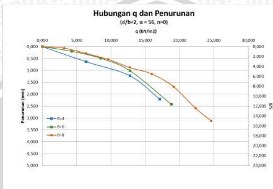
Gambar 4.21 Grafik Hubungan Q_u Dan Penurunan Tanah Pada Lereng Perkuatan Dengan Kemiringan Lereng = 56^\circ
