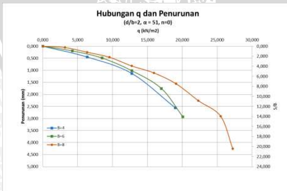
Gambar 4.20. Grafik Hubungan Q_u Dan Penurunan Tanah Pada Lereng Perkuatan Dengan Kemiringan Lereng = 51^\circ
