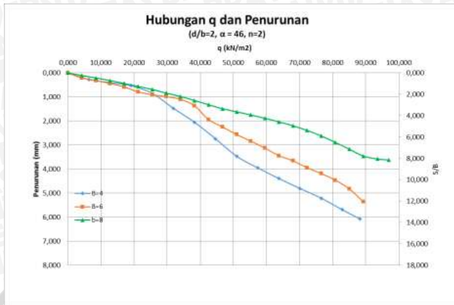
Gambar 4.25 Grafik Hubungan Q_u Dan Penurunan Tanah Pada Lereng Perkuatan Dengan Kemiringan Lereng 46^\circ
