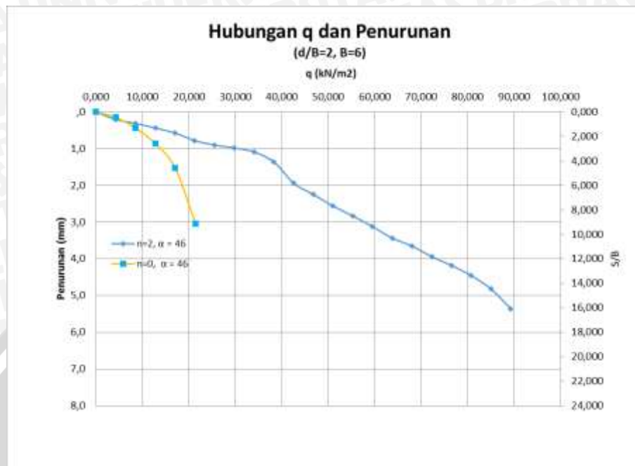
Gambar 4.31 Grafik Hubungan Q_u Dan Penurunan Tanah Pada Lereng Perkuatan Dan Tanpa Perkuatan Dengan Kemiringan Lereng 46^\circ .
