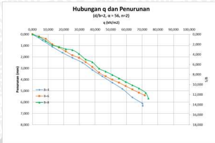
Gambar 4.27 Grafik Hubungan Q_u Dan Penurunan Tanah Pada Lereng Perkuatan Dengan Kemiringan Lereng 56^\circ
