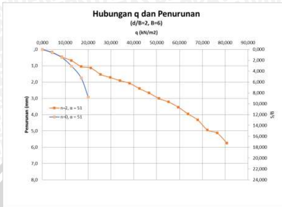
Gambar 4.32 Grafik Hubungan Q_u Dan Penurunan Tanah Pada Lereng Perkuatan Dan Tanpa Perkuatan Dengan Kemiringan Lereng 51^\circ .
