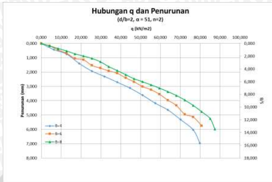
Gambar 4.26 Grafik Hubungan Q_u Dan Penurunan Tanah Pada Lereng Perkuatan Dengan Kemiringan Lereng 51^\circ
