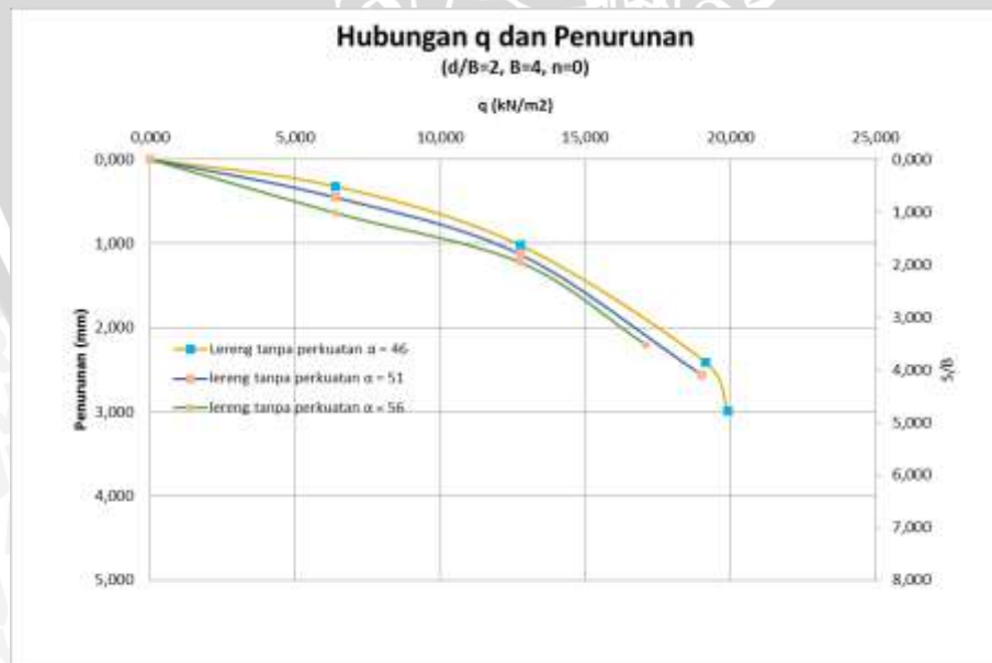
Gambar 4.16 Grafik Hubungan Qu Dan Penurunan Tanah Pada Lereng Tanpa Perkuatan Dengan Lebar Pondasi (B) = 4 cm
