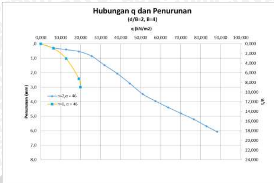
Gambar 4.28 Grafik Hubungan Q_u Dan Penurunan Tanah Pada Lereng Perkuatan Dan Tanpa Perkuatan Dengan Kemiringan Lereng 46^\circ .
