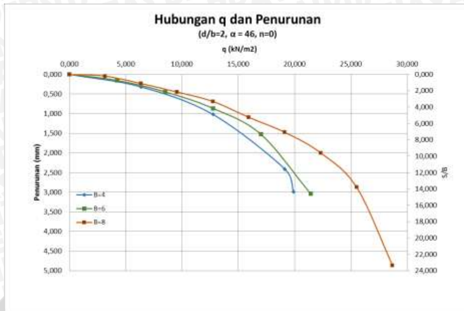
Gambar 4.19 Grafik Hubungan Q_u Dan Penurunan Tanah Pada Lereng Perkuatan Dengan Kemiringan Lereng = 46^\circ
