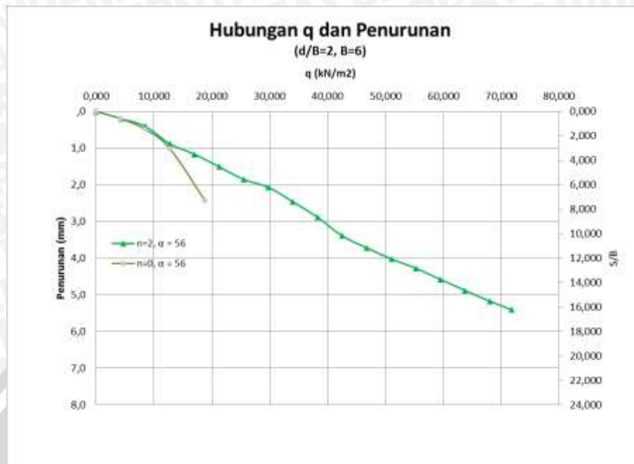
Gambar 4.33 Grafik Hubungan Q_u Dan Penurunan Tanah Pada Lereng Perkuatan Dan Tanpa Perkuatan Dengan Kemiringan Lereng 56^\circ .
