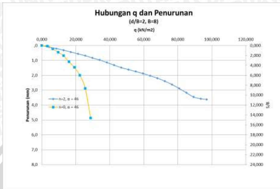
Gambar 4.34 Grafik Hubungan Q_u Dan Penurunan Tanah Pada Lereng Perkuatan Dan Tanpa Perkuatan Dengan Kemiringan Lereng 46^\circ .
