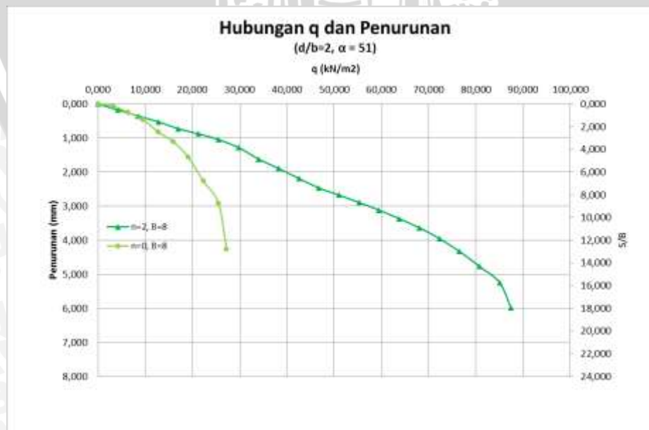
Gambar 4.42 Grafik Hubungan Q_u Dan Penurunan Tanah Pada Lereng Perkuatan Dan Tanpa Perkuatan Dengan Lebar Pondasi B=8 cm.
