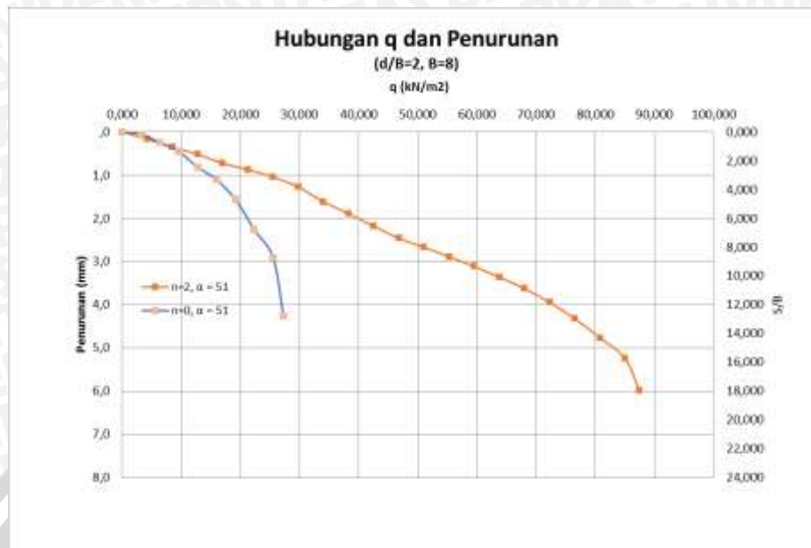
Gambar 4.35 Grafik Hubungan Q_u Dan Penurunan Tanah Pada Lereng Perkuatan Dan Tanpa Perkuatan Dengan Kemiringan Lereng 51^\circ .
