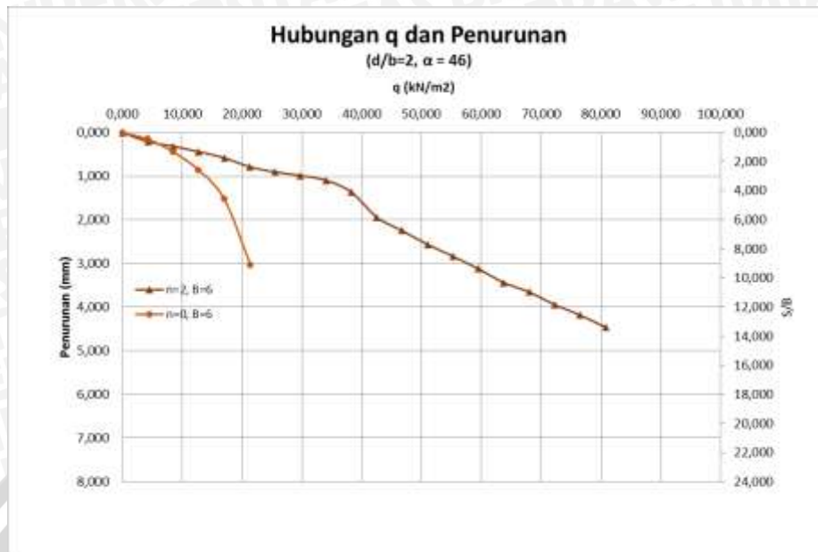
Gambar 4.38 Grafik Hubungan Q_u Dan Penurunan Tanah Pada Lereng Perkuatan Dan Tanpa Perkuatan Dengan Lebar Pondasi B=6 cm.
