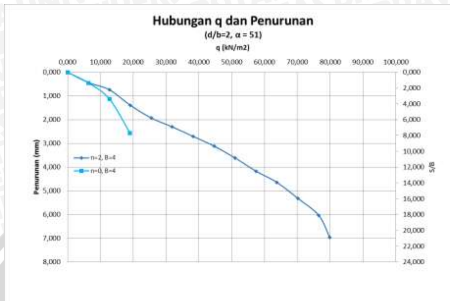
Gambar 4.40 Grafik Hubungan Q_u Dan Penurunan Tanah Pada Lereng Perkuatan Dan Tanpa Perkuatan Dengan Lebar Pondasi B=4cm.
