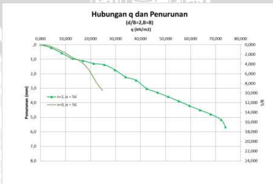
Gambar 4.36 Grafik Hubungan Q_u Dan Penurunan Tanah Pada Lereng Perkuatan Dan Tanpa Perkuatan Dengan Kemiringan Lereng 56^\circ .
