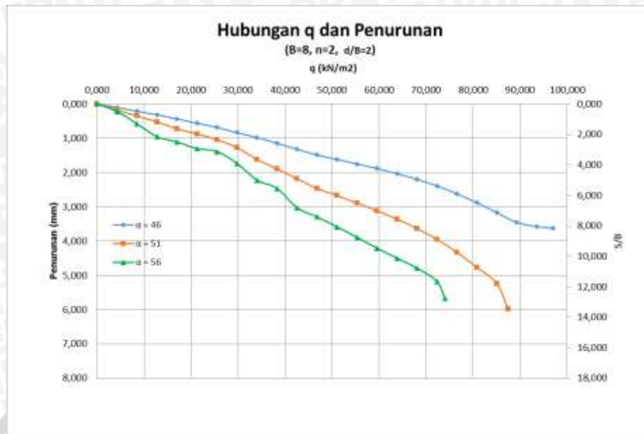
Gambar 4.24 Grafik Hubungan Q_u Dan Penurunan Tanah Pada Lereng Perkuatan Dengan Lebar Pondasi ( B ) = 8 cm
