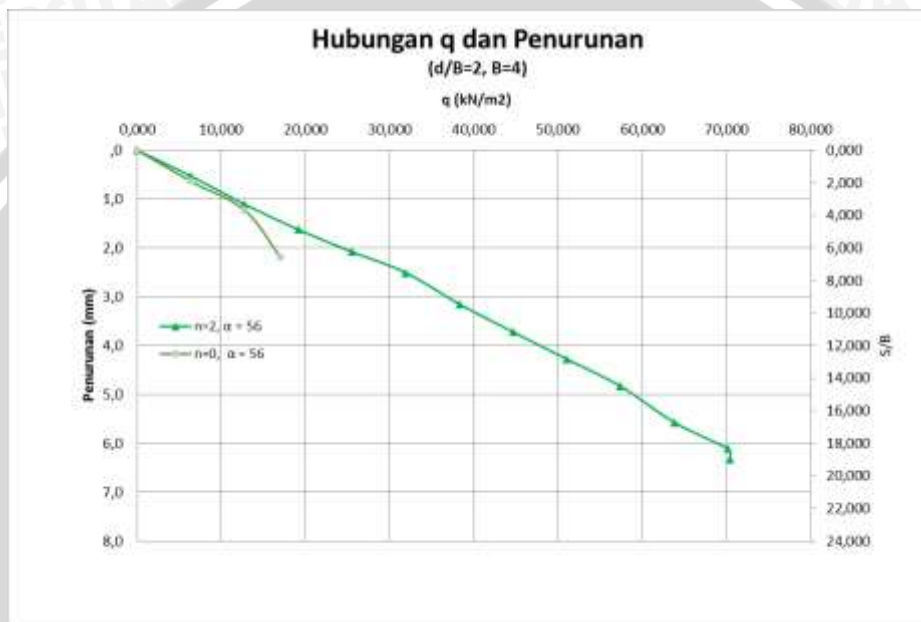
Gambar 4.30 Grafik Hubungan Q_u Dan Penurunan Tanah Pada Lereng Perkuatan Dan Tanpa Perkuatan Dengan Kemiringan Lereng 56^\circ .
