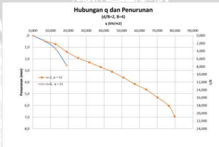
Gambar 4.29 Grafik Hubungan Q_u Dan Penurunan Tanah Pada Lereng Perkuatan Dan Tanpa Perkuatan Dengan Kemiringan Lereng 51^\circ .
