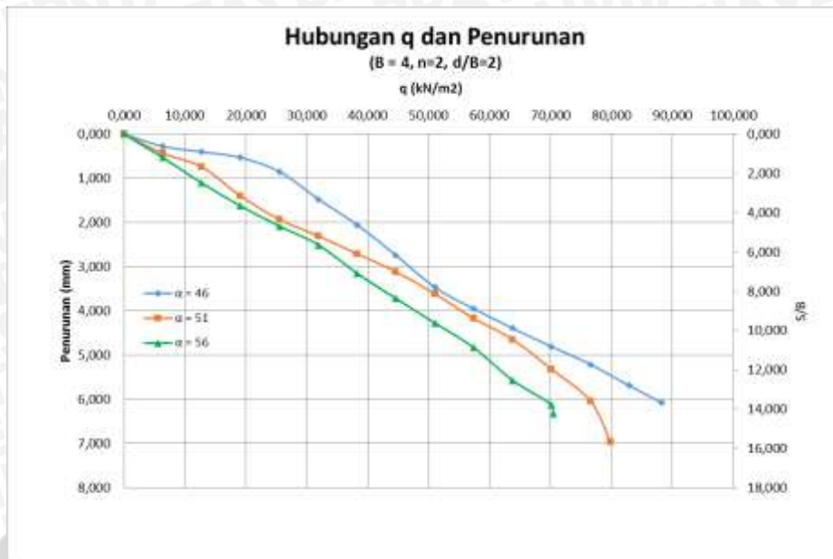
Gambar 4.22 Grafik Hubungan Qu Dan Penurunan Tanah Pada Lereng Perkuatan Dengan Lebar Pondasi ( B = 4 cm
