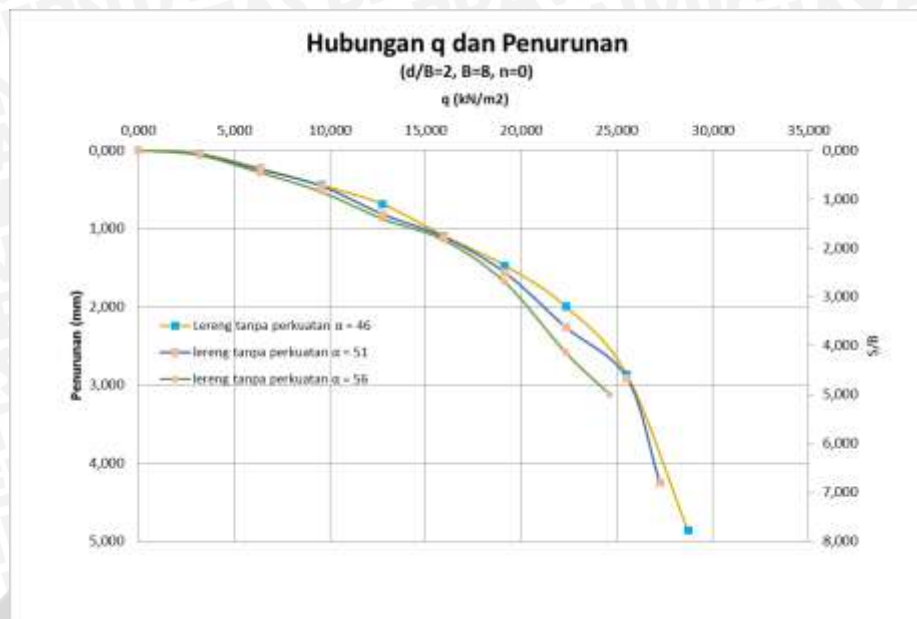
Gambar 4.18 Grafik Hubungan Q_u Dan Penurunan Tanah Pada Lereng Tanpa Perkuatan Dengan Lebar Pondasi ( B ) = 8 cm
