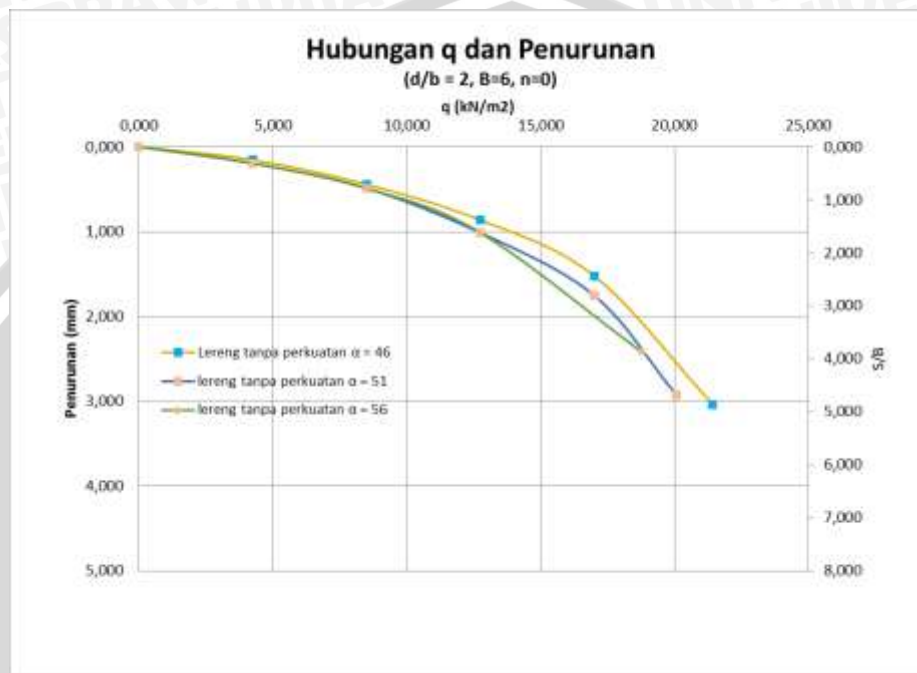
Gambar 4.17 Grafik Hubungan Q_u Dan Penurunan Tanah Pada Lereng Tanpa Perkuatan Dengan Lebar Pondasi (B) = 6 cm
