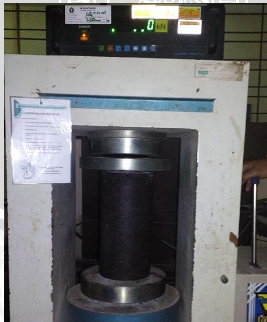
Gambar 4.6 Skema pengujian kuat tekan beton
