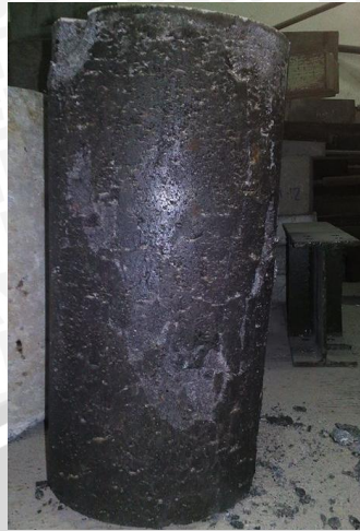
Gambar 4.7 Silinder beton setelah diuji kuat tekan
