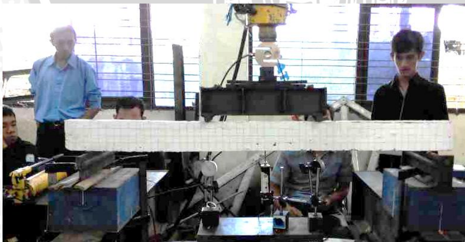
Gambar 4.10 Pemasangan aktual benda uji lentur balok
