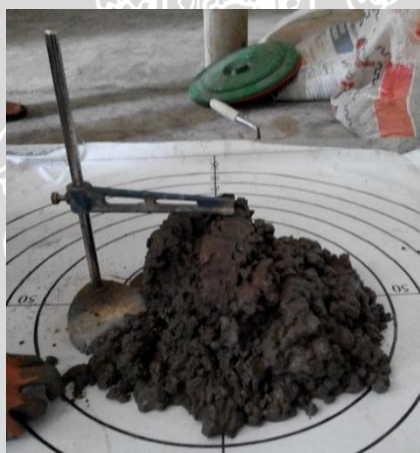
Gambar 4.1 Pengujian slump beton
