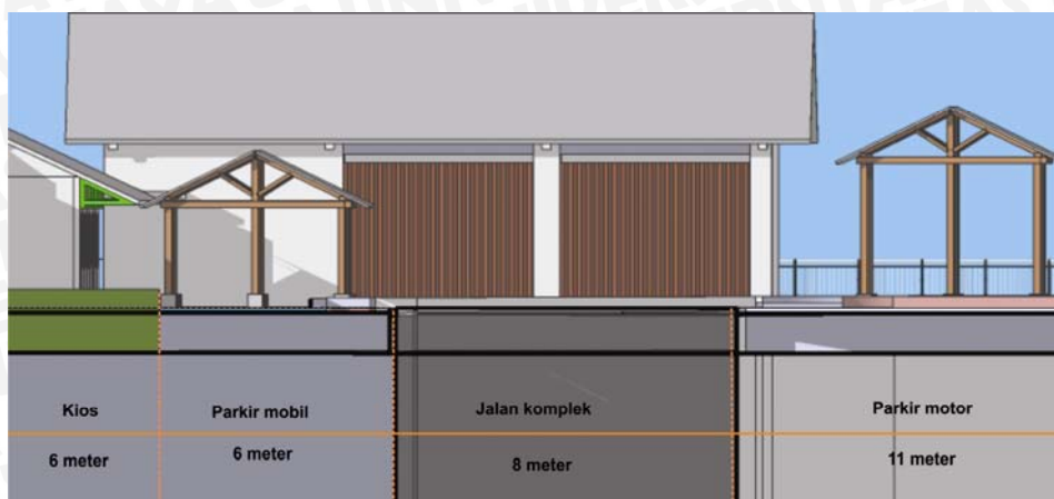
Gambar 4.69 Dimensi Jalan Pada Zona Perbaikan PPP Pondokdadap
