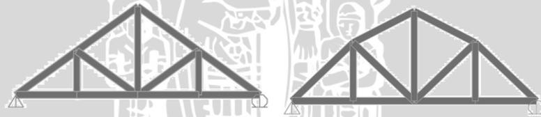
(a) Bentuk umum rangka batang pada atap bangunan
