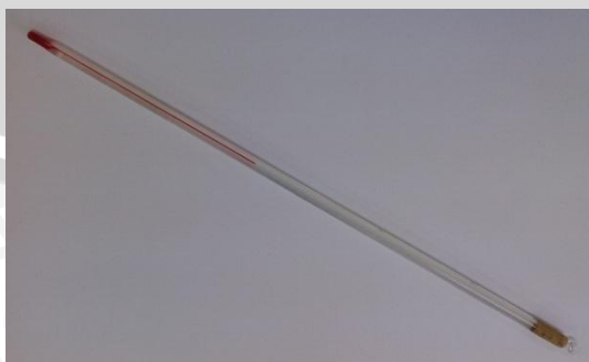
Gambar 3.2 Termometer air raksa
