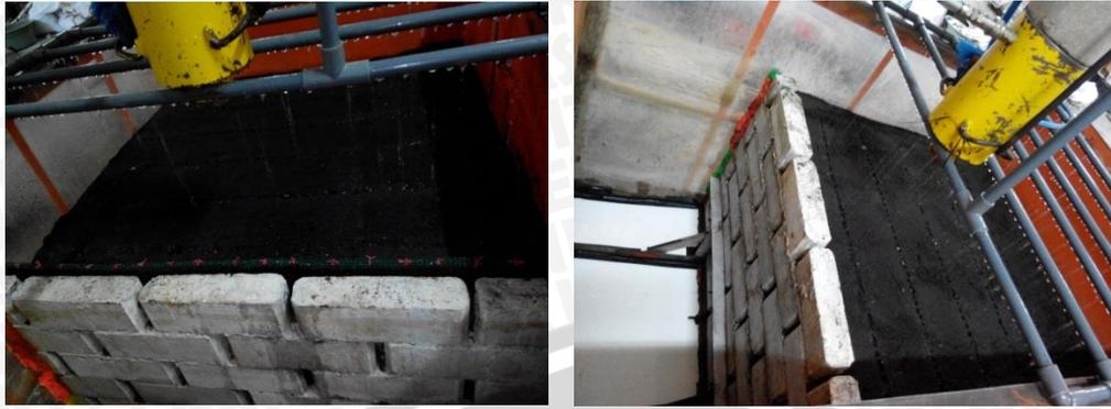
**Gambar 4.3.3** Pengujian butiran yang lolos celah : (a) pengujian dengan menggunakan ijuk ; (b) pengujian tanpa menggunakan ijuk
