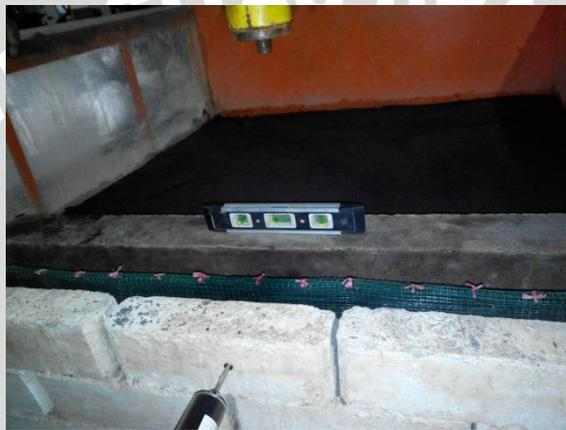
**Gambar 4.3.1** Pemasangan *waterpass*
