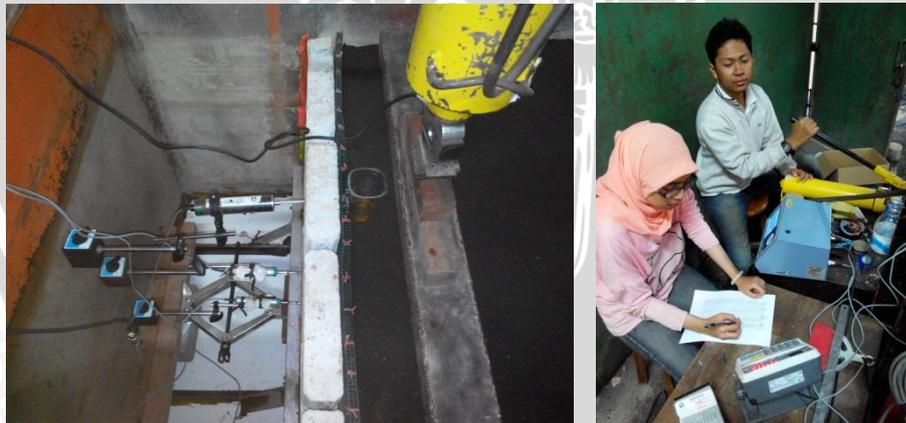
**Gambar 4.3.2** Pengujian deformasi lateral : (a) alat yang digunakan dalam pengujian ;
