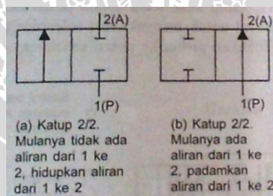
Gambar 2.11 Katup Kontrol direksional 2/2:
