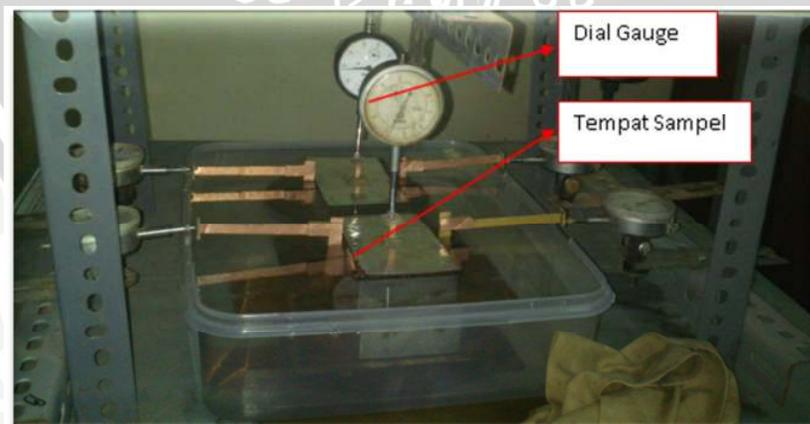
**Gambar 1.1** Alat Uji *Swelling* Arah Vertikal dan Horizontal
