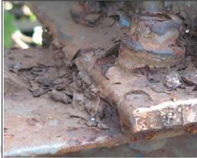
Gambar 2.4 Pengotor yang Mempercepat Korosi pada Permukaan Logam
