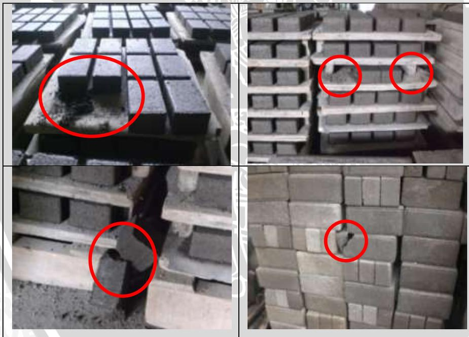
Gambar 4.8 Produk *Defect* Paving Kotak
