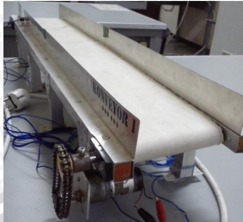
Gambar 4.15 Konveyor (Sumber: Perancangan, 2014)
