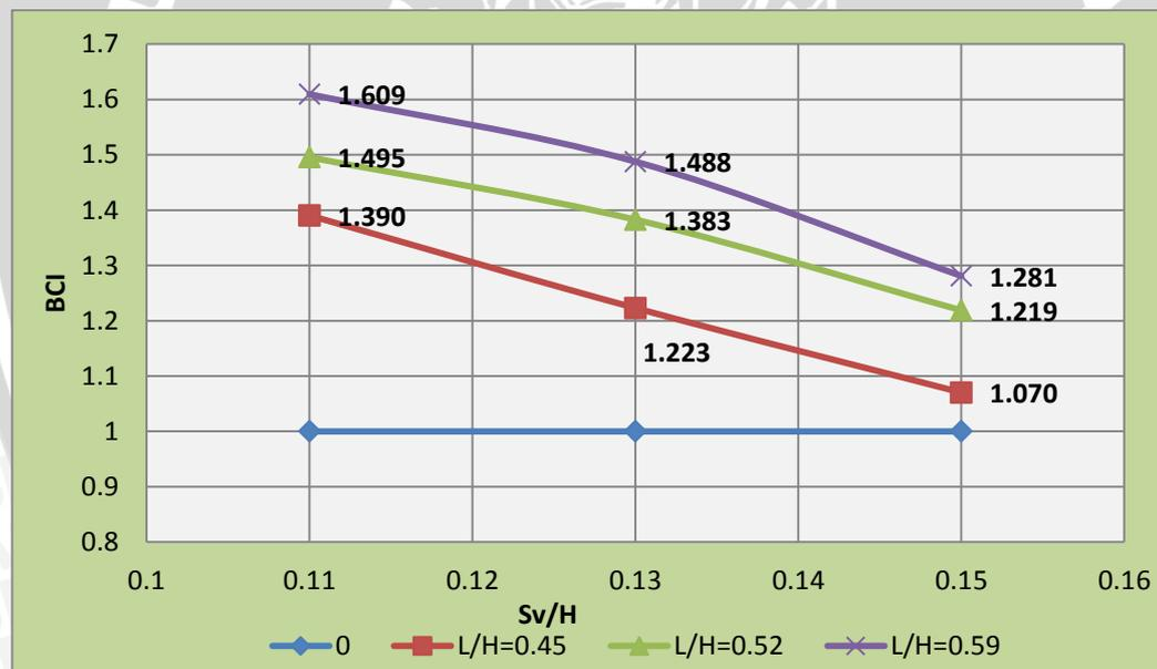
**Gambar 4.26** Grafik perbandingan peningkatan  $BCI_{(s)}$  untuk variasi jarak vertikal antarlapis geotekstil pada  $s/B=6\%$
