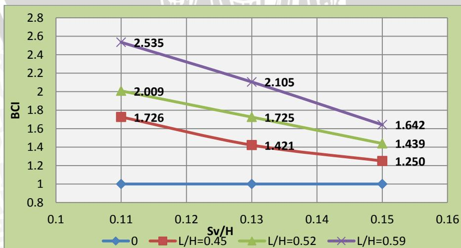
**Gambar 4.20** Grafik perbandingan peningkatan  $BCI_{(s)}$  untuk variasi panjang lapisan geotekstil pada  $s/B=2\%$
