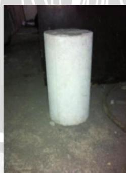
**Gambar 3.5** Alat untuk pemadatan berupa silinder beton
