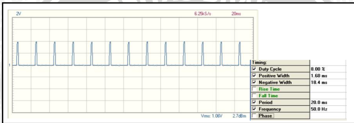
Gambar 5.7 Sinyal Input PWM dengan Pulse 1500 \mu s (Perancangan)
