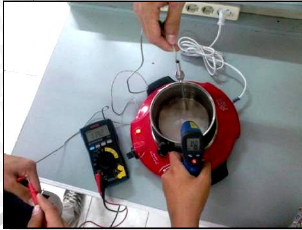
Gambar 5.1 Pengujian Resistansi Sensor PT100 (Perancangan)
