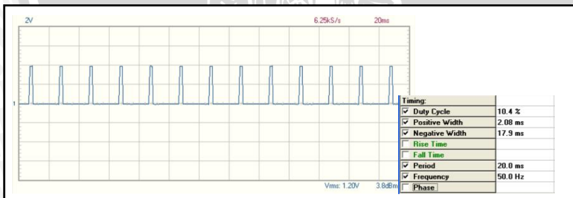
Gambar 5.8 Sinyal Input PWM dengan Pulse 2000 \mu s (Perancangan)
