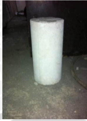
Gambar 3.5 Peralatan untuk pemadatan berupa silinder beton
