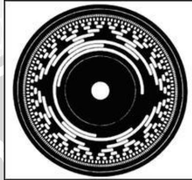
**Gambar 2.8 Contoh Susunan Pola 16 Cincin Konsentris pada Absolut Encoder**
