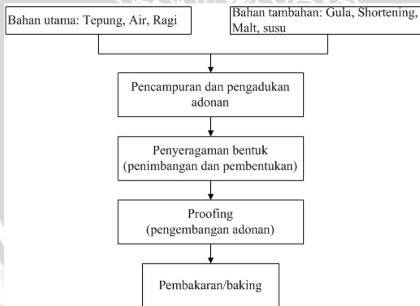
Gambar 2.1 Diagram Alir Proses Pembuatan Roti (UKM MR Bakery)
