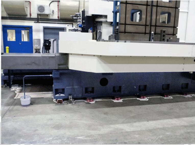
**Gambar 2. 21** Hasil akhir mesin dan pondasi yang telah terpasang
