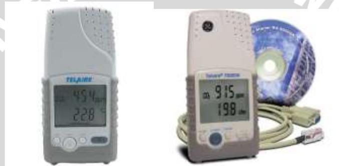
Gambar 3.12 Alat pengukur CO<sub>2</sub> (telaire)
