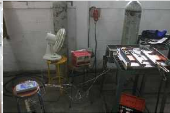
Instalasi induksi magnet untuk pengelasan
