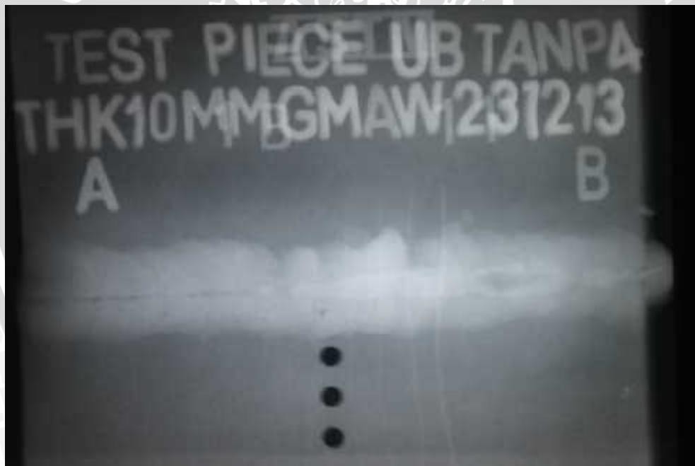
Gambar 4.2 Foto sambungan las pada film negatif hasil uji radiografi.
