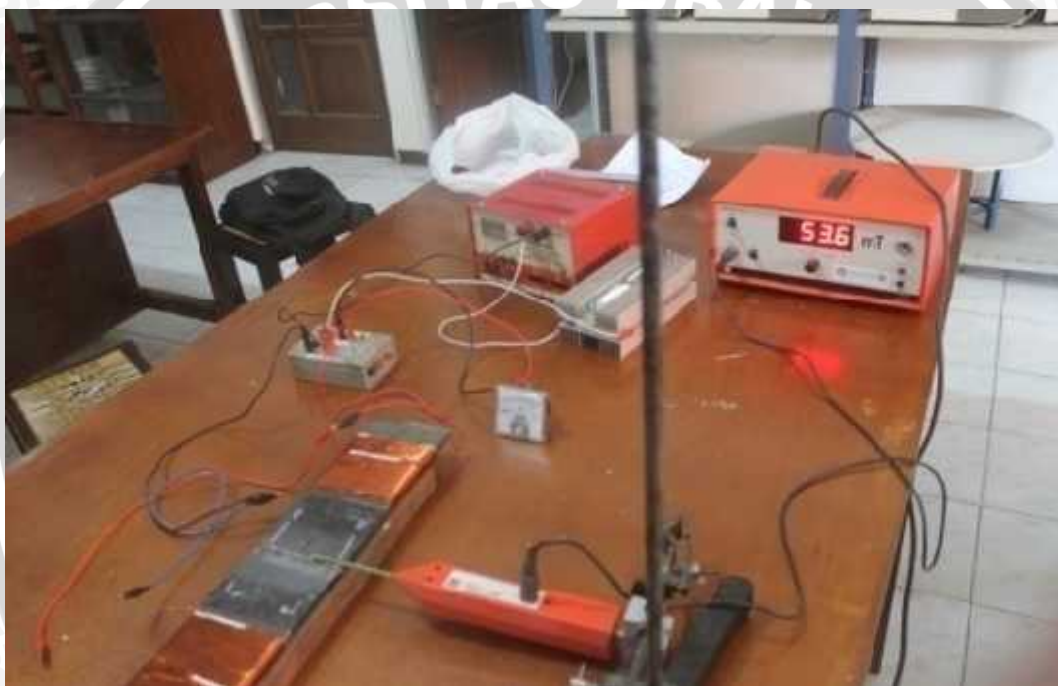
Gambar 4.1 Instalasi pengujian besar induksi magnet eksternal.
