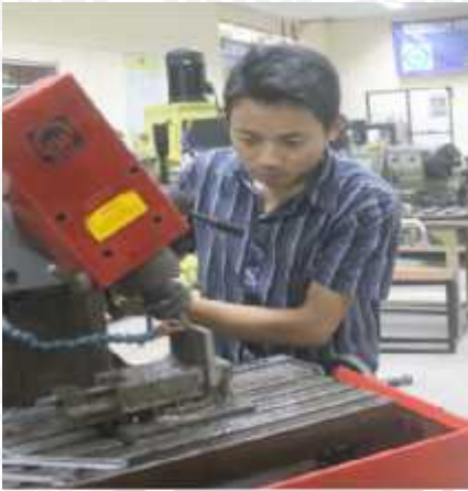
Pemotongan spesimen pengelasan
