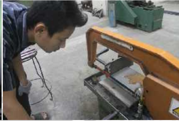
Pemotongan spesimen las untuk foto mikro
