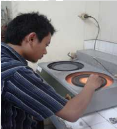
Penghalusan spesimen foto mikro
