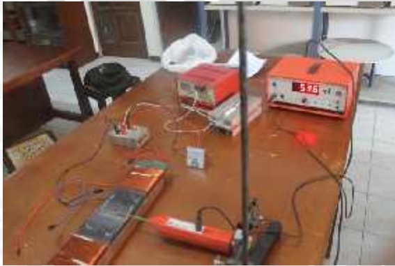
Pengujian besar induksi magnet solenoida
