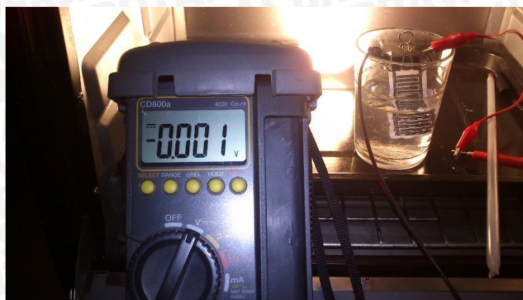
Gambar 5.4. Pengujian Sensor Konduktivitas dengan suhu ruangan 84°C
