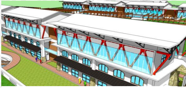
Gambar 26 : Struktur Belt-Truss system sebagai struktur lantai 2.
