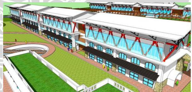
Gambar 28 : Satu modul massa (atas). Rangkaian modul-modul membentuk massa bangunan utama (bawah).
