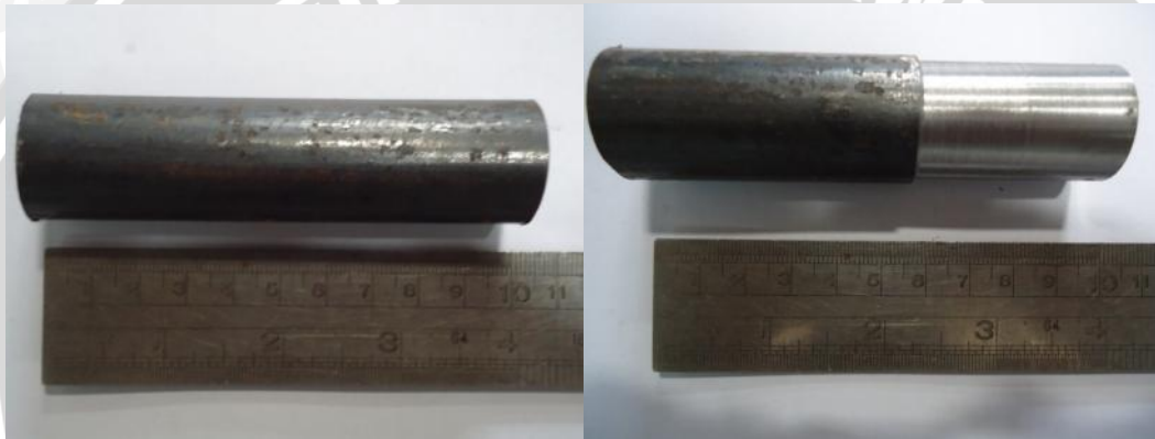
Gambar 4.1 : Gambar spesimen sebelum dan sesudah pembubutan
