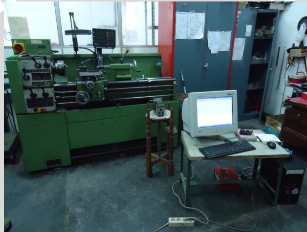
Gambar 3.1 Instalasi pengujian getaran dan gaya pada proses pemotongan.
