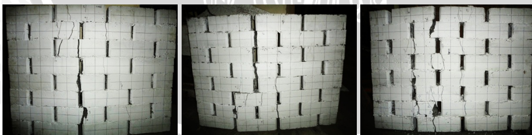
Gambar 4.4.4 Retak pada dinding bercelah A1, A2 dan A3 (Sumber: Hasil eksperimen)
