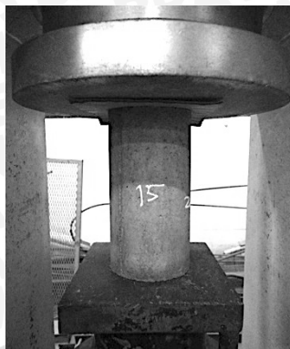
Gambar 4.1.1 Uji tekan beton penyusun bata beton bertulang (Sumber: Hasil eksperimen)
