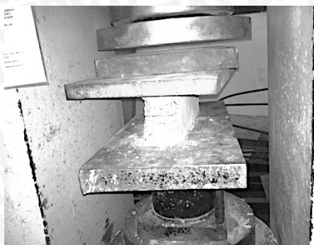
Gambar 4.1.4 Uji tekan bata beton bertulang (Sumber: Hasil eksperimen)
