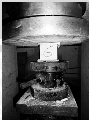
Gambar 4.1.7 Uji tekan mortar dan grouting (Sumber: Hasil eksperimen)
