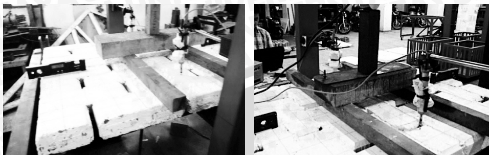
Gambar 4.2.2 Pemasangan aktual benda uji dinding bercelah (Sumber: Hasil eksperimen)
