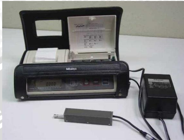
Gambar 3.2 : Surface Roughness Test Sumber : Dokumentasi pribadi
