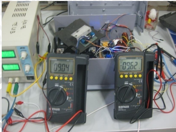
Gambar 5.20 Hasil Pengujian Pertama Masukan Lampu LED dengan Tegangan Masukan 9V
