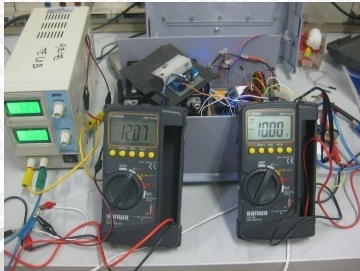
Gambar 5.22 Hasil Pengujian Ketiga Masukan Lampu LED dengan Tegangan Masukan 12V
