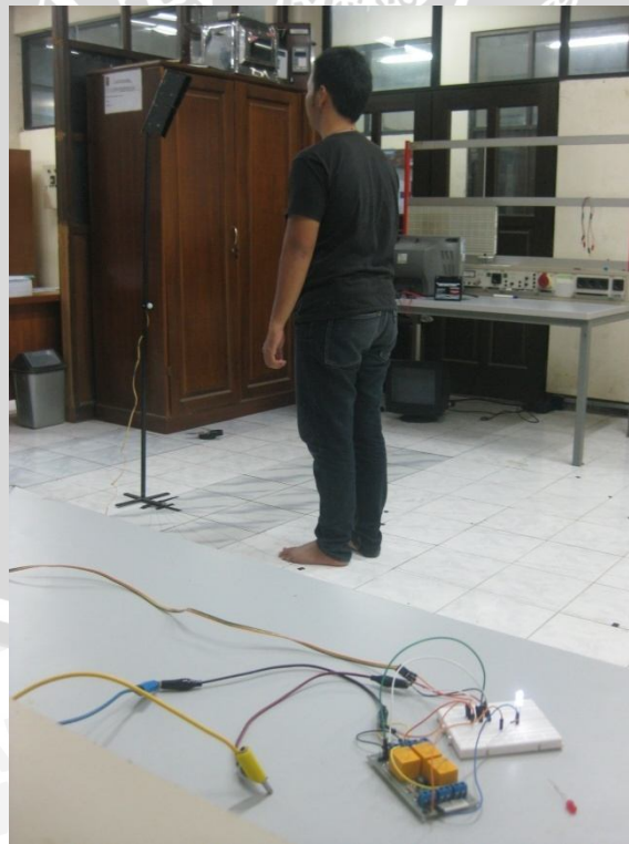
Gambar 5.17 Hasil Pengujian Deteksi Gerakan dengan Jarak 1 meter Sudut 0°
