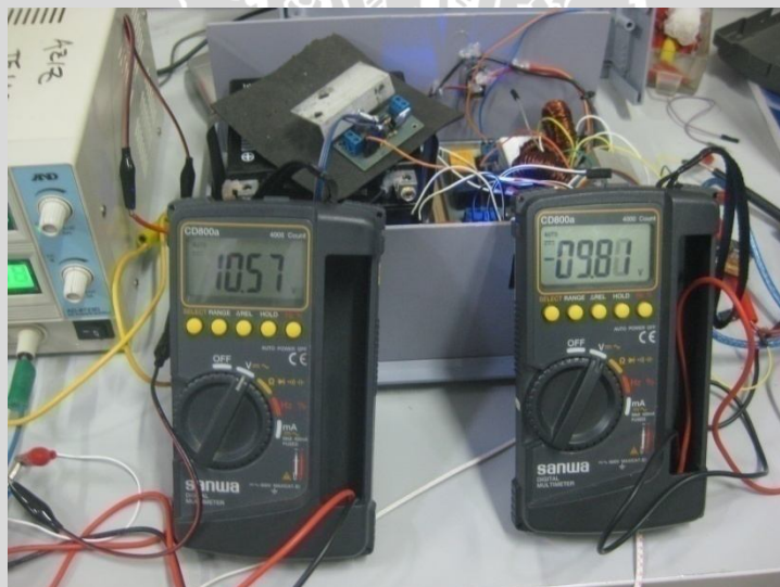
Gambar 5.21 Hasil Pengujian Kedua Masukan Lampu LED dengan Tegangan Masukan 10,5V
