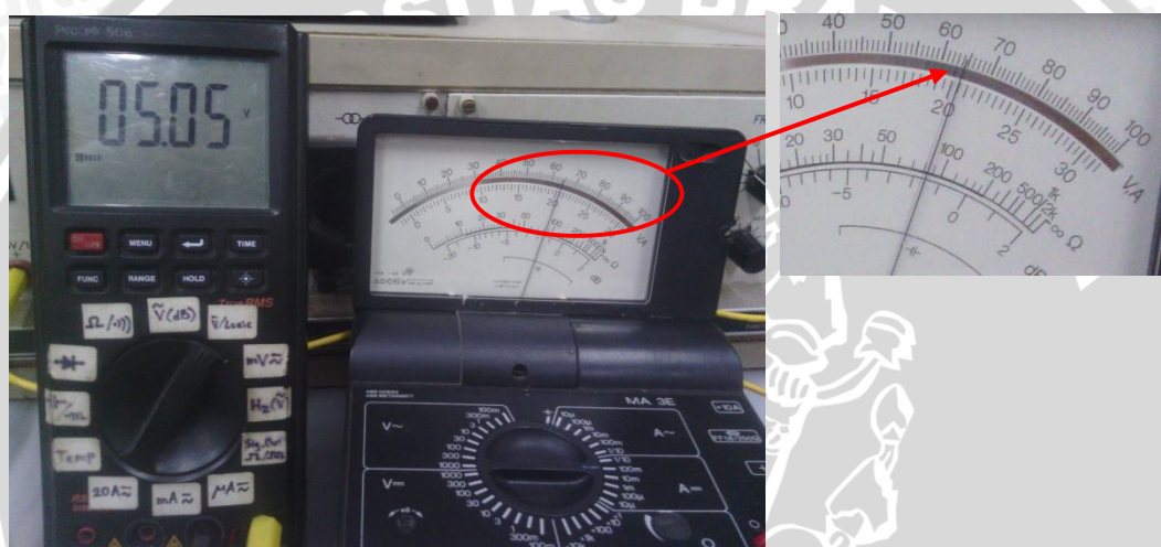
Gambar 5.2 Hasil Pengujian Arus Kumparan Relay dengan Catu Tegangan 5V
