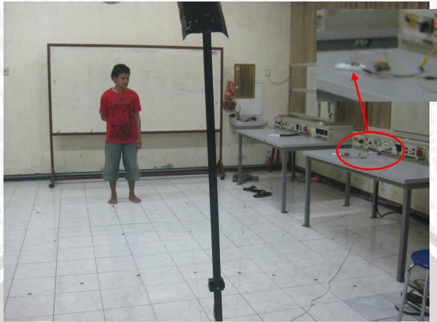
Gambar 5.18 Hasil Pengujian Deteksi Gerakan dengan Jarak 4 meter Sudut 0^\circ
