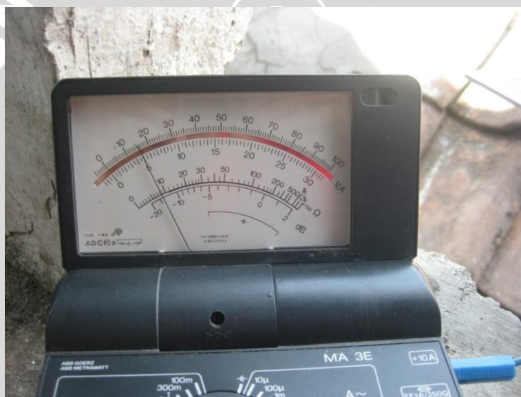
Gambar 5.4 Hasil Pengujian Arus Charging Pada Proses Pengisian Accu
