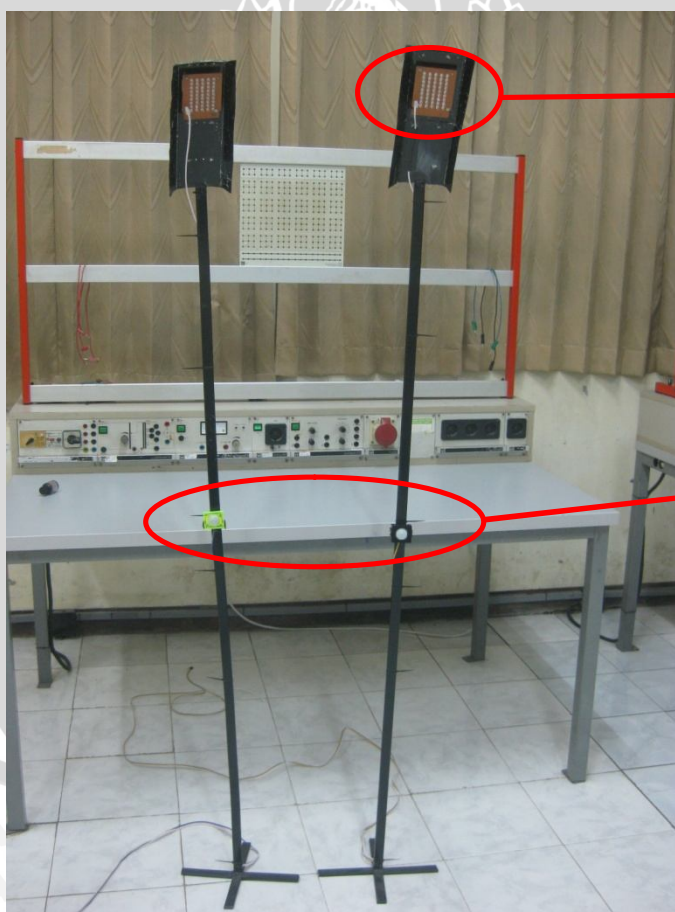
Gambar. 4 Lampu Penerangan dengan Sensor PIR
