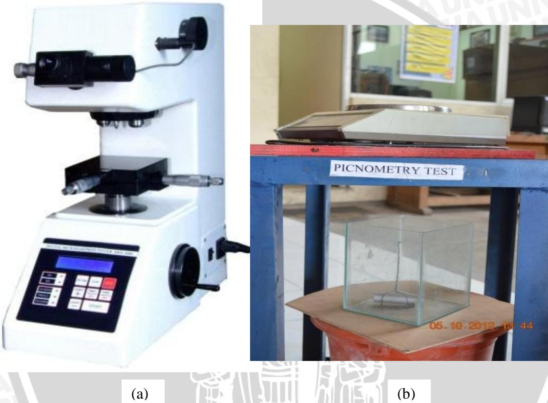
Gambar 3.2. Peralatan pengujian ; a. Alat Uji Kekerasan Mikro Vickers Hardness Tester, b. Alat Uji Piknometri
