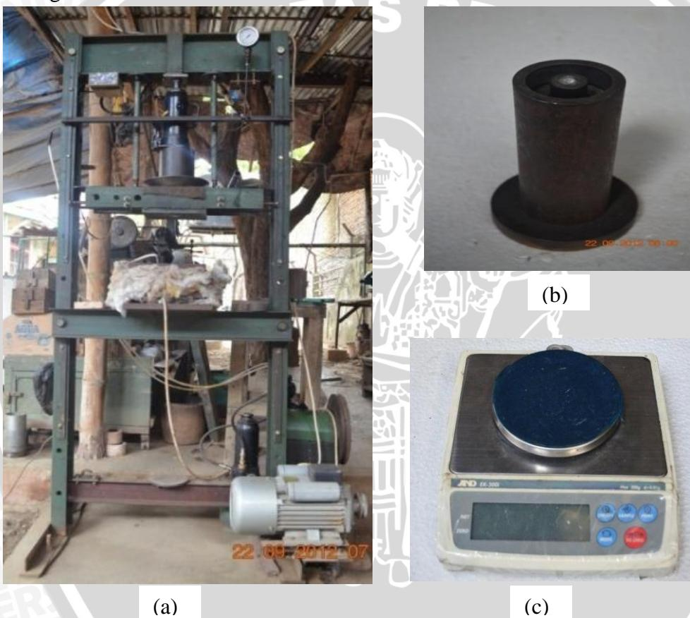
Gambar 3.1. Peralatan pembuatan specimen ; a. Mesin *Hot Pressing*, b. Cetakan, c. Timbangan Elektrik.
