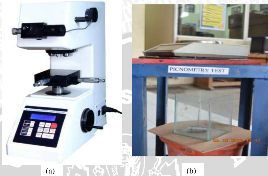
Gambar 3.2. Peralatan pengujian: (a) alat uji kekerasan Micro Vickers, (b) alat uji piknometri
