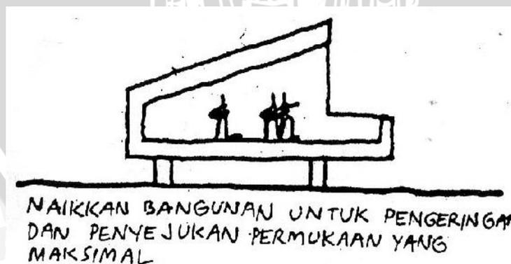
Gambar 2.10 Konstruksi bangunan panggung untuk pengeringan dan penyejukan permukaan yang maksimal
