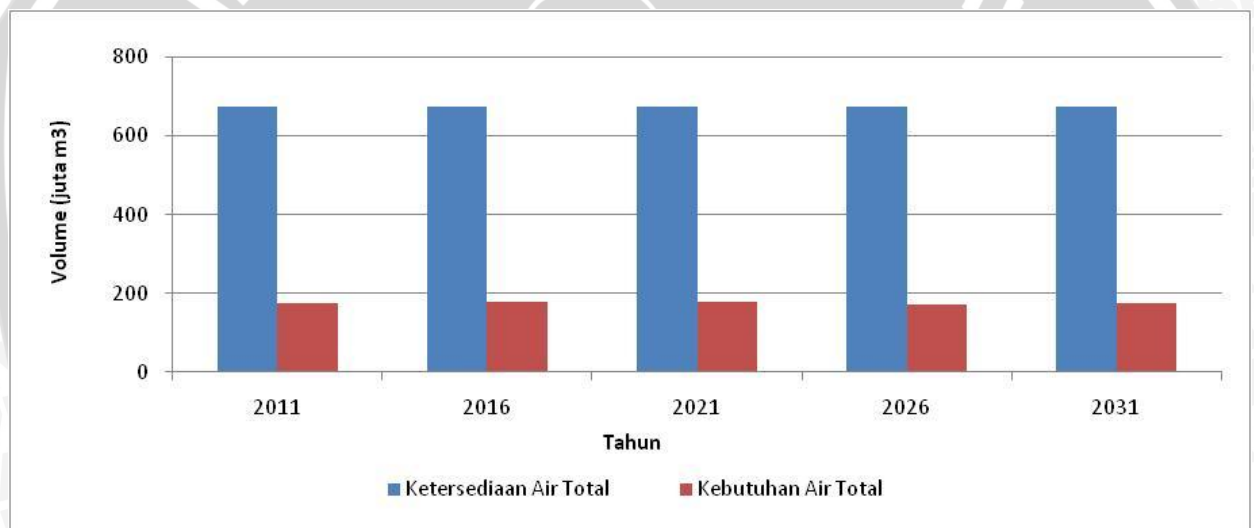
Gambar 4.22. Neraca Air Sub DAS Sumber Brantas Untuk Skenario-1 (dengan Debit Metode F.J. Mock)
