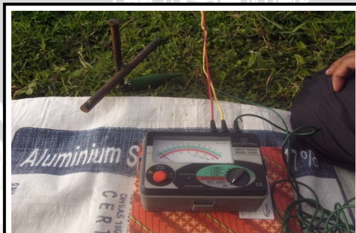
Gambar L-5. Pengukuran resistansi pembumian dengan pemberian arang tempurung kelapa
