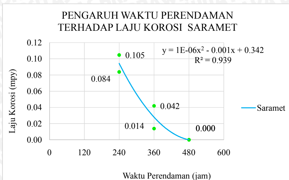
Gambar 4.5 Grafik hubungan waktu terhadap laju korosi Saramet
