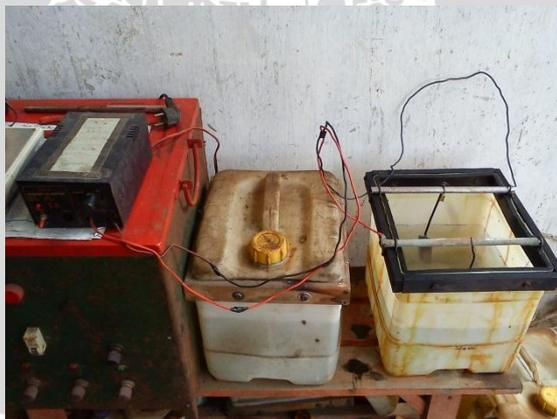
Gambar 3.7. Elektrolisis *Cell*
