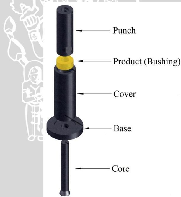
Gambar 3.11. Susunan Cetakan
